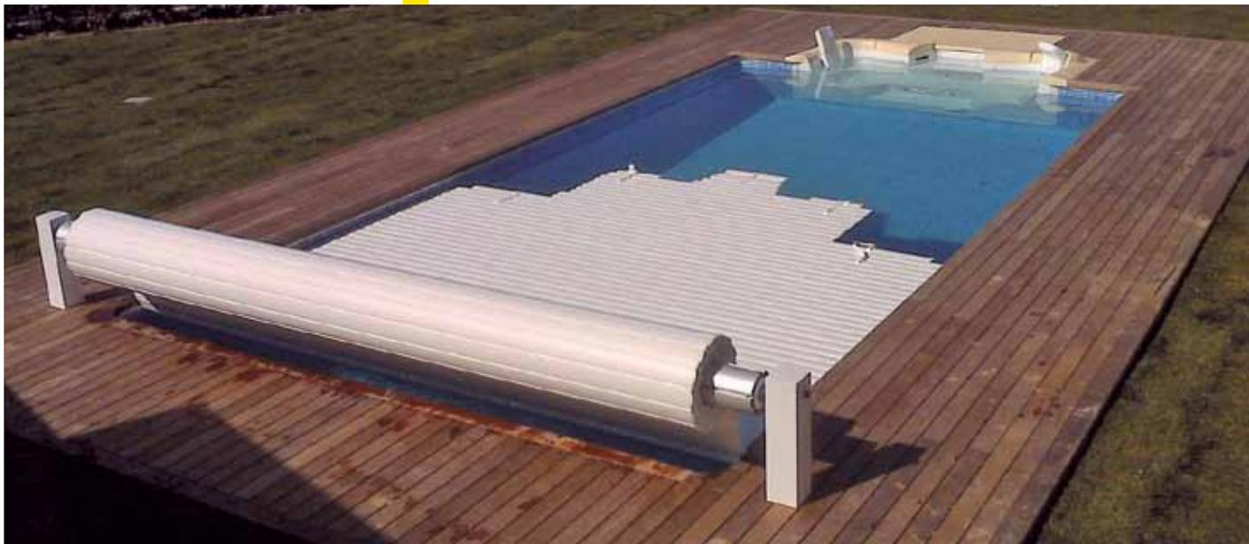
Cubiertas compuestas por lamas de perfil extrusionado de PVC o policarbonato de alta resistencia que cumplen con la normativa NPF-308 de seguridad. Son perfiles de cámaras huecas sellados por los extremos que aseguran su flotabilidad.
