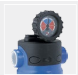
Manómetro diferencial de presión que indica el grado de saturación del filtro.
